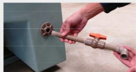
**DRENO DO EQUIPAMENTO:** A drenagem do reservatório é feita durante a lavagem do climatizador, na qual pode ser acoplada mangueira ou tubulação rígida que possa conduzir a água usada para esgoto ou ralo. O dreno é utilizado somente durante a troca de água e limpeza do reservatório interno. É importante que juntamente com a tubulação de saída de água seja instalado um registro para realizar a drenagem.
